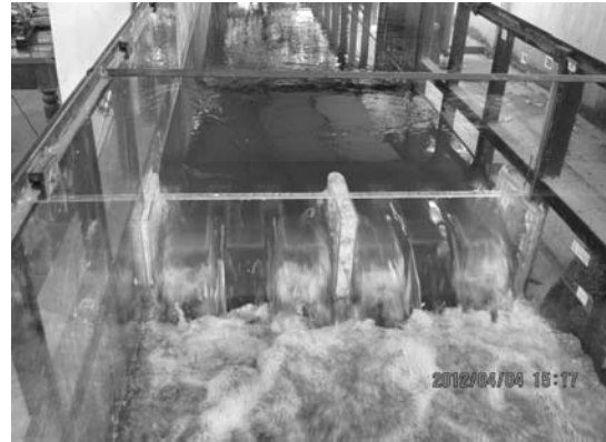
Chảy tự do, có co hẹp bên (có trụ pin)
