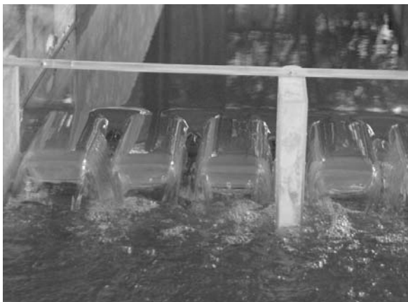
Chảy tự do h_n/H = -0,26 ( H/P=0,4 – dòng chảy không bị ảnh hưởng bởi trụ pin)
