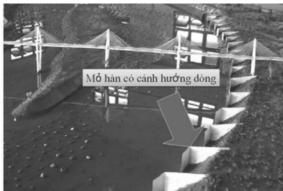
Hình 8. Lưu hướng dòng chảy mặt sau khi lắp cánh hướng dòng cho hệ thống MH Tâm Xá
