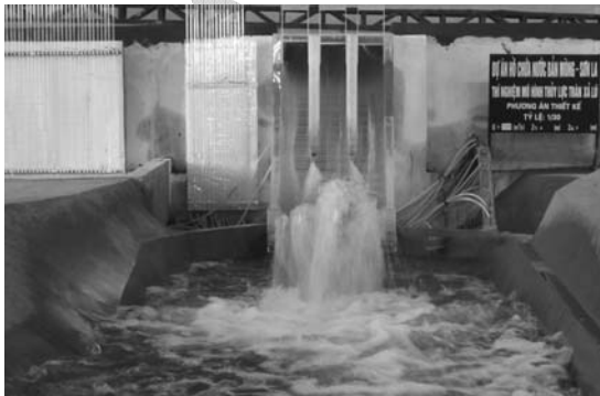
a/ Dòng phun không đều sau trần khi xả lũ mở cả 3 cửa – phương án thiết kế
