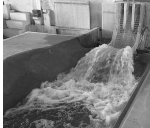
b/ Dòng phun đều hơn sau tràn khi xả lũ thường xuyên – phương án mũi phun không liên tục
