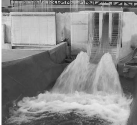
a/ Dòng phun không đều sau tràn khi xả lũ thường xuyên – phương án thiết kế
