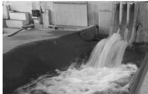
b/ Dòng phun đều hơn sau trần khi xả lũ mở cả 3 cửa – phương án mũi phun không liên tục
