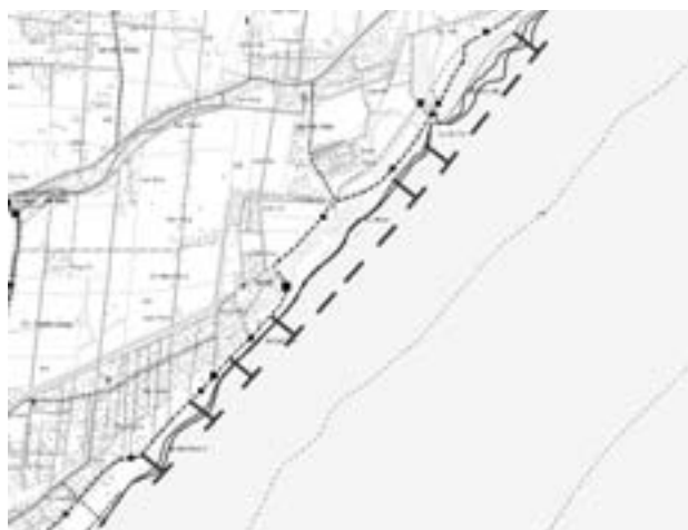
Hình 3.6. Tính toán biến động đường bờ khu vực Hải Hậu khi bãi có công trình
