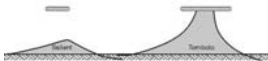
Hình 2.1. Hai hình thái điển hình cho diễn biến đường bờ sau đê ngầm
