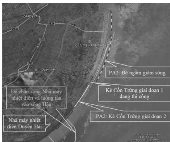
Hình 9. Giải pháp chỉnh trị khu vực xã Trường Long Hòa – Phương án 1
