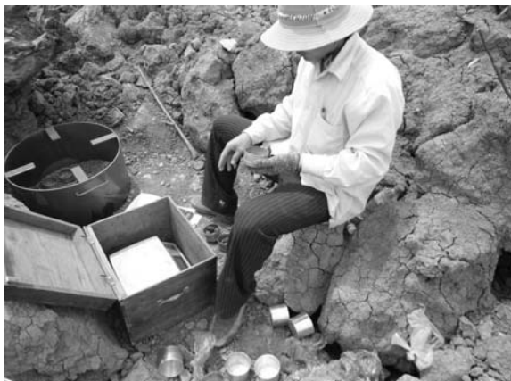
Hình 1: Thí nghiệm kết cấu đất đầm nén tại hiện trường công trình hồ chứa nước Ia Mor tỉnh Gia Lai
