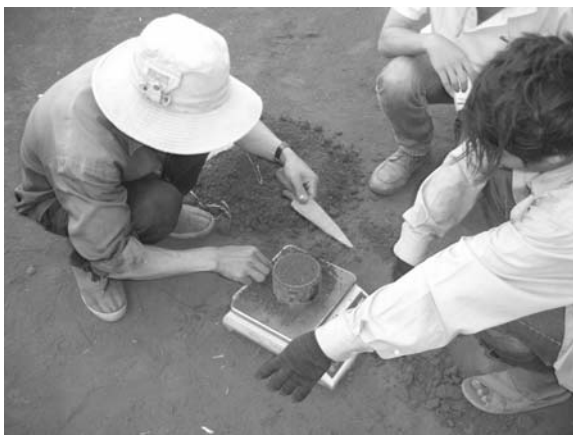
Hình 2: Thí nghiệm vật liệu đắp đập Krong Buk hạ tỉnh Đắk Lắk
