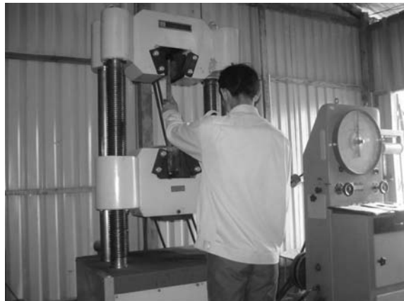
Hình 4: Thí nghiệm kéo thép tại hiện trường.
