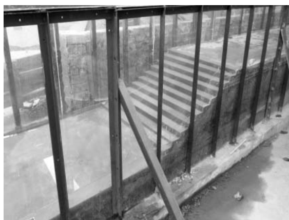
Hình 6. Mô hình lòng cứng với bậc dài 4m, cao trình đỉnh đập 45m nhìn theo phương vuông góc trục dòng chảy
