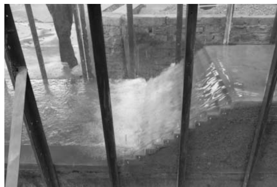
Hình 2: Dòng chảy trượt ngoài mũ bậc Q=1000 \text{ m}^3/\text{s} .
