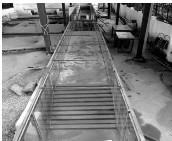
Hình 5. Mô hình lòng cứng với bậc dài 4m, cao trình đỉnh đập 45m nhìn từ hạ lưu
