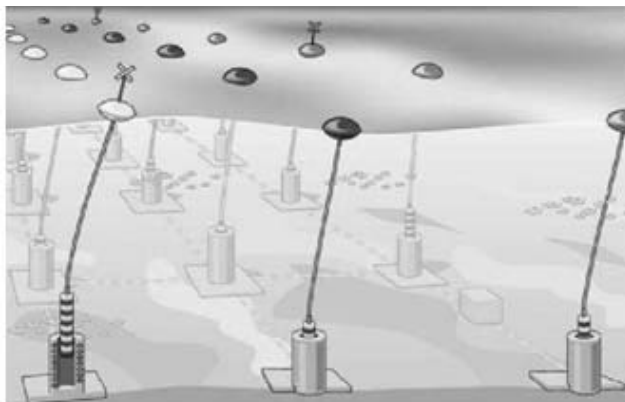
Hình 3. Cấu tạo của thiết bị phao nổi .[mccatchydc.com]
