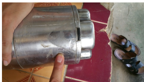
Hình 9. Dấu vết trên thân bơm và vị trí bị hư hỏng [5]
