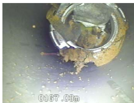
Hình 11. Một giếng khác, bơm bị mắc kẹt trong giếng khoan [5]
