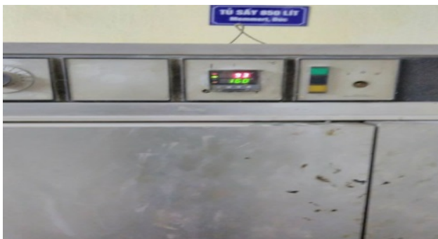
Hình 2. Sấy mẫu bê tông
