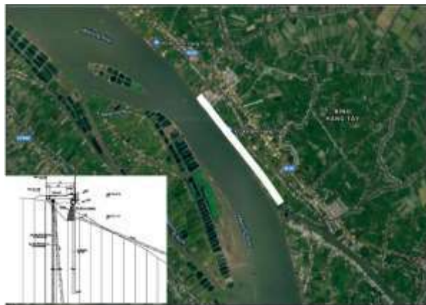
Hình 13: Công trình kè bảo vệ trực tiếp
