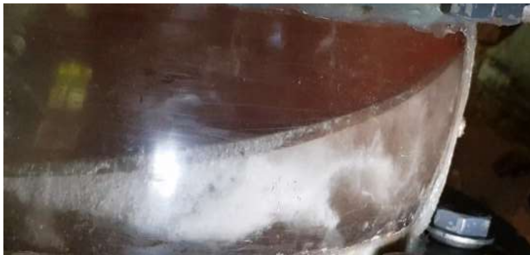
Dòng chảy trong buồng bánh công tác khi bị xâm thực mạnh
