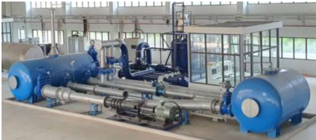
Hệ thống thí nghiệm máy bơm kiểu kín của Viện Bơm và Thiết bị thủy lợi
