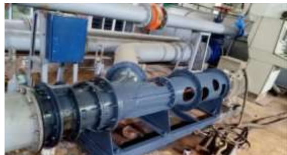
Hình 4: Hệ thống thí nghiệm máy bơm hướng trục n_s \approx 1200 v/ph (Viện Bơm và Thiết bị thủy lợi)
