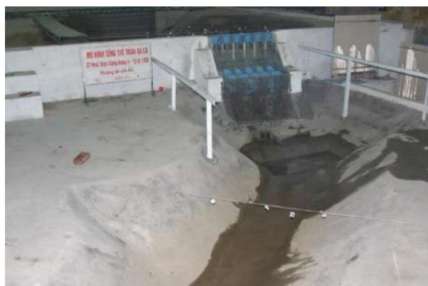
Ảnh 3: Mô hình tổng thể phương án mũi phun hai tầng nhìn từ hạ lưu
