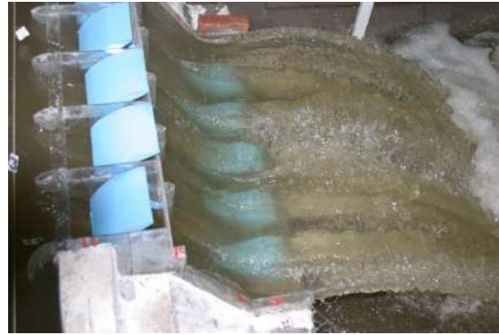
Ảnh 4: Dòng chảy qua mũi phun hai tầng
