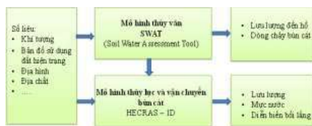
Hình 1: Sơ đồ kết hợp giữa mô hình SWAT và mô hình HECRAS
