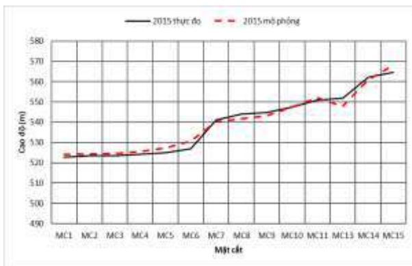
Hình 6: Cao độ đáy hồ thực đo và mô phỏng giai đoạn hiệu chỉnh 2015 và kiểm định mô hình – năm 2018
