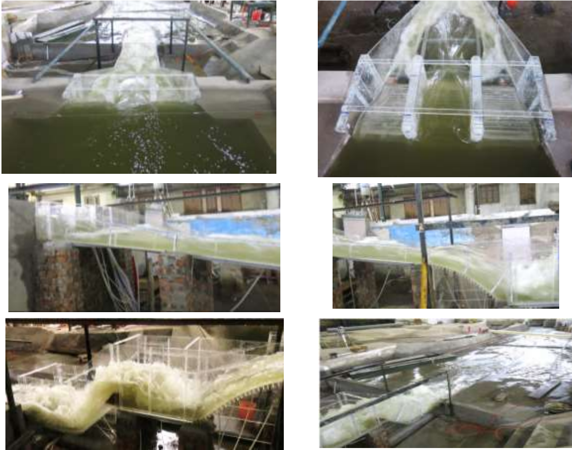
Hình 5: Các hiện tượng thủy lực bất lợi dọc công trình tràn Đạ Sĩ
