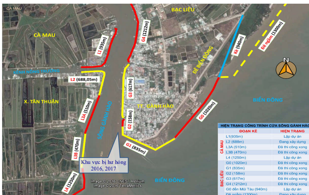
Hình 2: Sơ đồ vị trí các đoạn kè đã và đang xây dựng khu vực cửa sông Gành Hào
