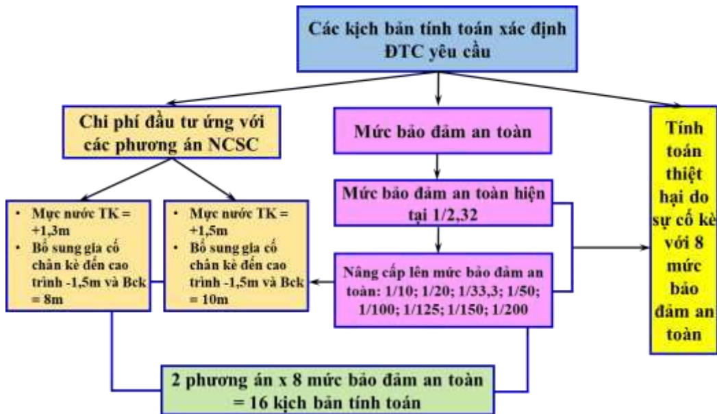
Hình 3: Các kịch bản tính toán ĐTC yêu cầu của CTK bờ sông Sài Gòn đoạn Thủ Dầu Một
