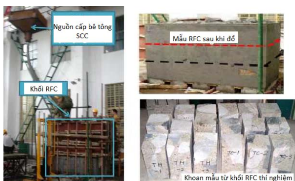
Hình 2.2 Chế tạo RFC và lấy mẫu thí nghiệm kiểm tra cường độ RFC
