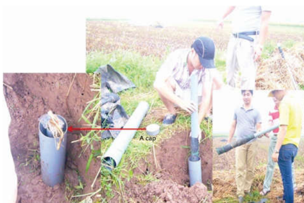
Hình 6. Lắp đặt các giếng cạn để theo dõi ảnh hưởng của thủy triều đến mực nước ngầm và thành phần hóa học của nước ngầm trong ruộng nghiên cứu
