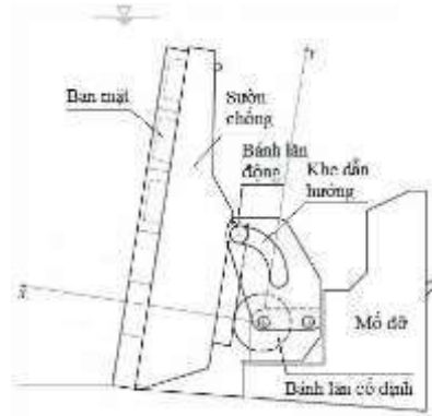
Hình 4: Cửa van tự lật kiểu bánh lăn có khe dẫn hướng
