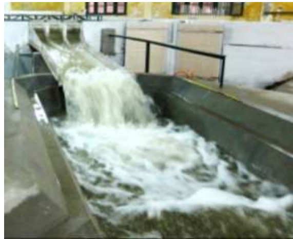
Ảnh 2: Dòng chảy qua mũi phun hai tầng
