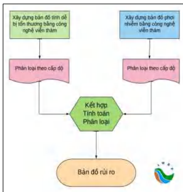
Hình 1: Xây dựng bản đồ rủi ro do lũ, ngập lụt bằng công nghệ viễn thám
