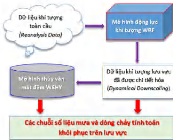
Hình 4. Quy trình tính toán khôi phục dữ liệu mưa và dòng chảy trên lưu vực bằng mô hình WEHY-WRF
