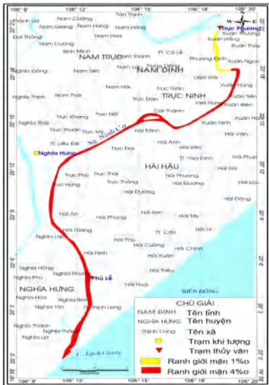
Hình 15: Minh họa kịch bản xâm nhập mặn sông Ninh Cơ kịch bản năm 2030
