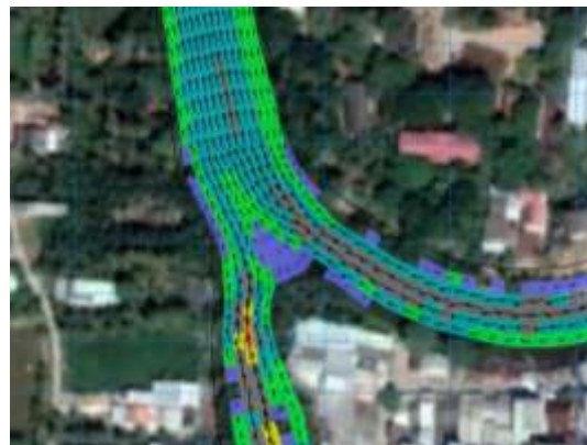
Hình 10: Hố xói xuất hiện tại khu vực ngã ba sông và thông số hình thái hai đoạn sông cong
