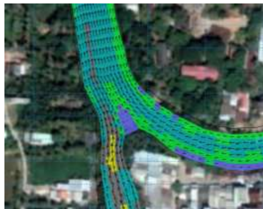
Hình 11: Kết quả mô phỏng trường vận tốc tại ngã ba sông Cầu Ngang trước và sau khi lấp hố xói ngày 13/6/2018 lúc 8:00 PM và 14/6/2018 lúc 8h00 AM
