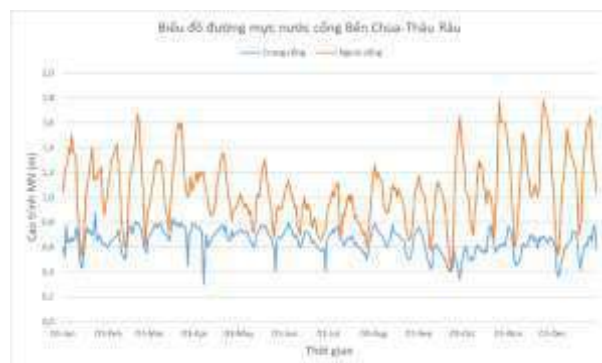
Hình 7: Biểu đồ đường mực nước phía trong và ngoài các cống điều tiết 2014
