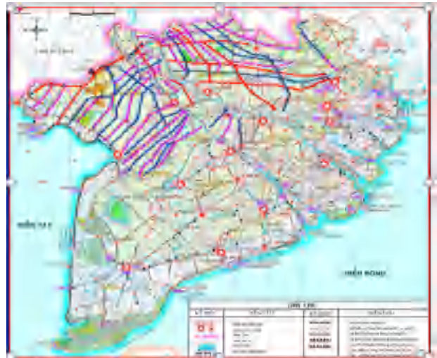
Hình 2: Một số hạng mục công trình chính kiểm soát lũ tràn biên giới, hệ thống kênh trục vùng lũ ĐBSCL
