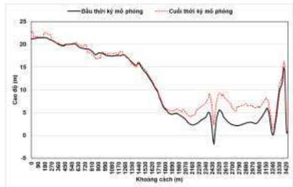
Hình 18: Diễn biến bồi xói theo thời gian tại các mặt cắt ngang hồ vị trí đập
