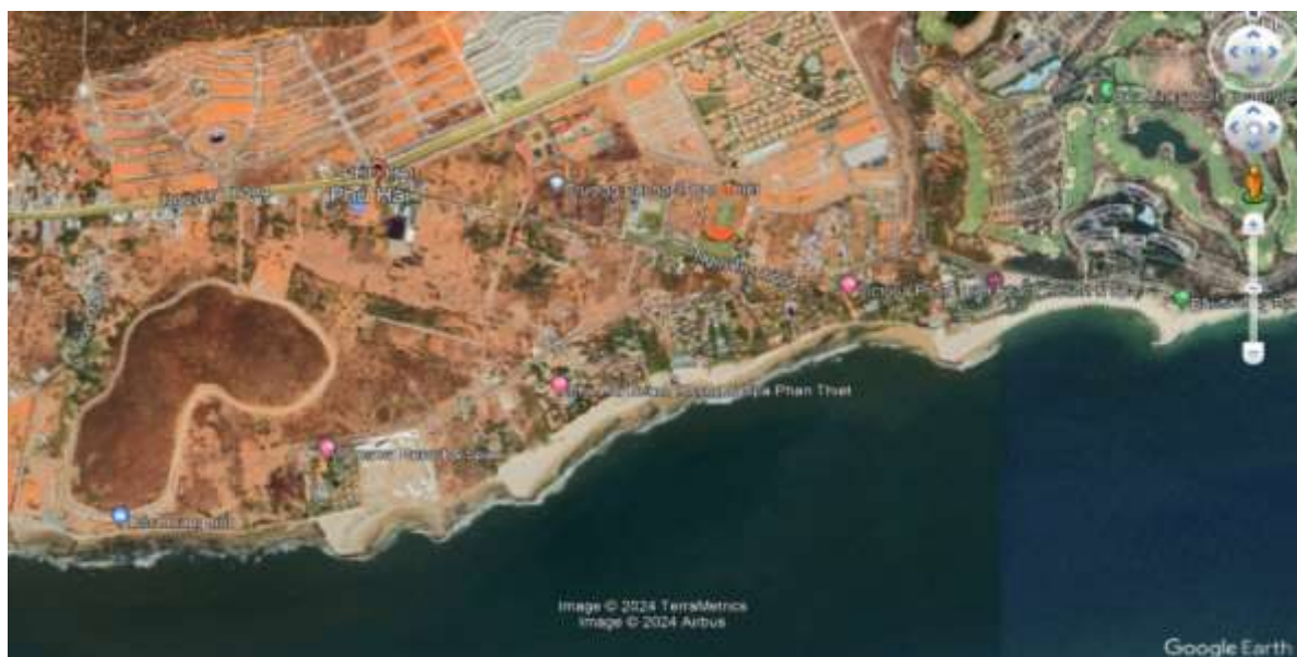
Hình 14: Hình thái đường bờ khu vực bãi tắm Romana - Cát Trắng - Phú Hải đang được hình thành các tiểu cung cong sau khi xây dựng các mỏ hàn lấn biển
