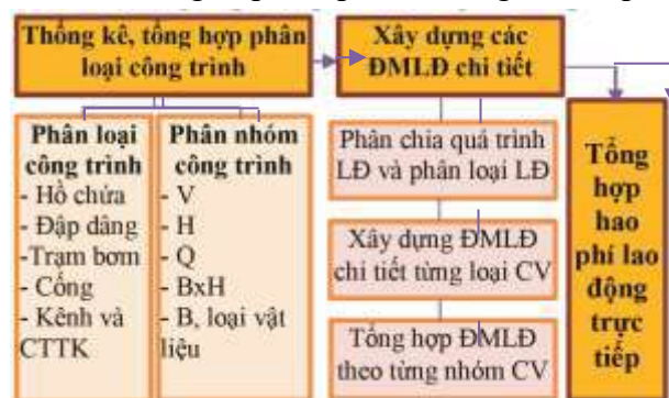
Hình 1: Trình tự xây dựng ĐMLĐ trực tiếp
