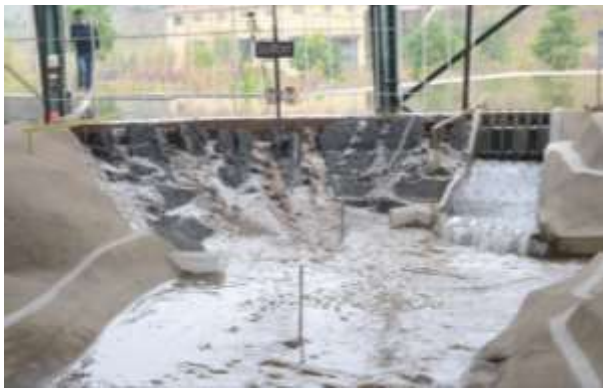
Hình 12: Thí nghiệm mô phỏng vỡ đập ở Phòng TNTĐ [20]
