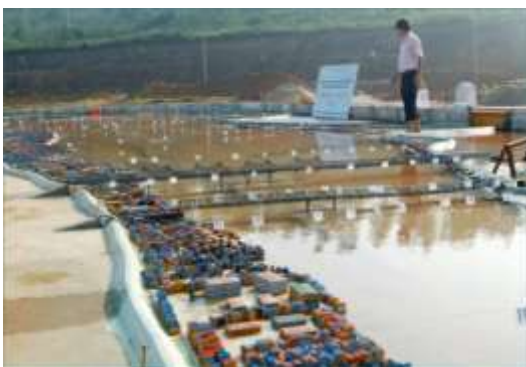
Hình 2: Mô hình thoát lũ, ổn định lòng sông Hồng khu vực Hà Nội, thí nghiệm năm 2002
