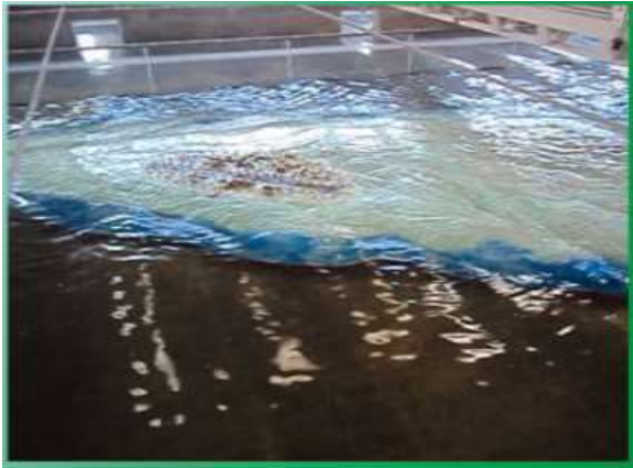
Hình 7: TN sóng trên đảo Trường Sa lớn (trái) và TN ổn định dàn khoan dầu khí kết cấu KCD khi vận chuyển trên biển (phải)
