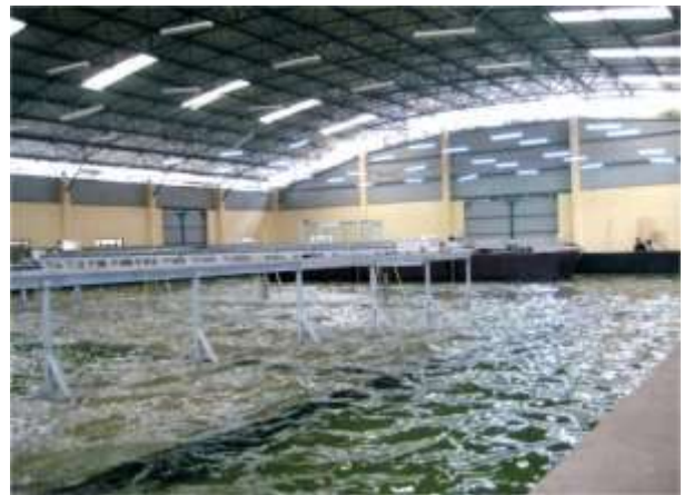
Hình 10: Bể tạo sóng triều kết hợp công nghệ Đan Mạch kích thước 40x27x1.0m tạo sóng đều và không đều trên nền thủy triều với độ sâu lớn nhất 25cm
