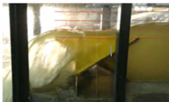
Hình 3: Các thành phần dòng chảy qua PKW
