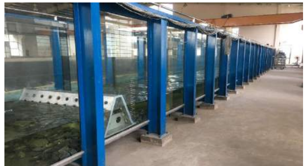
Hình 2.1: Thiết lập thí nghiệm truyền sóng qua đê giảm sóng kết cấu rỗng
