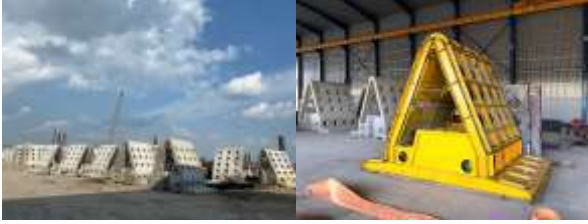
Hình 5: Sản xuất kết cấu rỗng TC1 trong nhà máy
