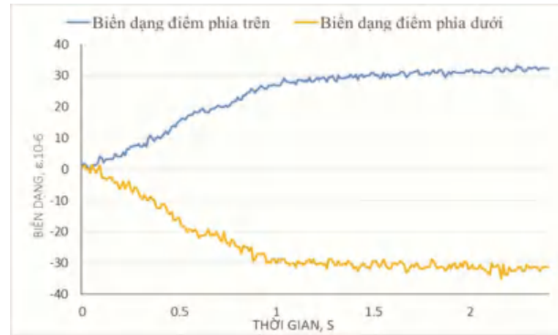
Hình 2.18: Kết quả đo biến dạng ứng với cấp tải P=1115\text{kg}
