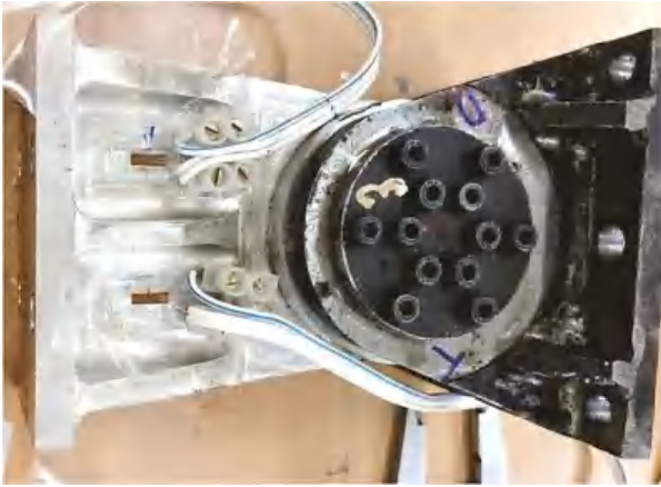
Hình 2.16: Vị trí cảm biến điện trở trên mô hình cốt động
