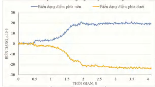
Hình 2.18: Kết quả đo biến dạng ứng với cấp tải P=770\text{kg}
