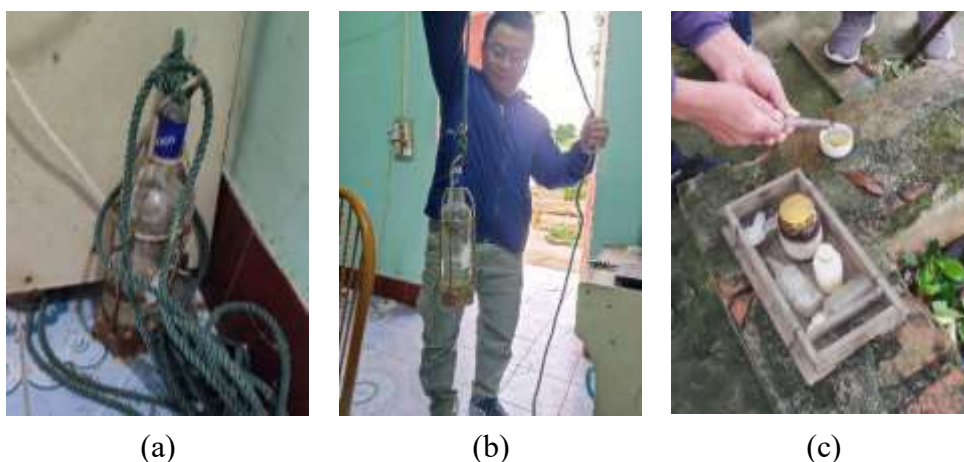
Hình 1: Phương pháp quan trắc mặn thủ công tại vùng nghiên cứu [3]: (a) Công cụ lấy mẫu (nước) thủ công; (b) Công nhân vận hành sử dụng công cụ để lấy mẫu; (c) Bộ công cụ “thí nghiệm” xác định độ mặn của nước theo phương pháp hóa học
