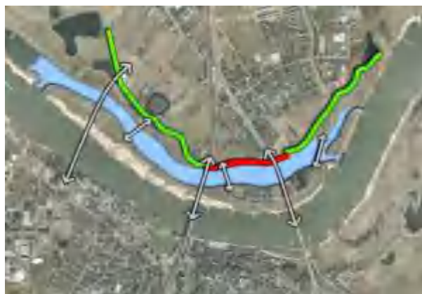
Hình 6: Xây dựng thêm tuyến kênh phụ trên bãi sông có công trình điều tiết (Hà Lan)
