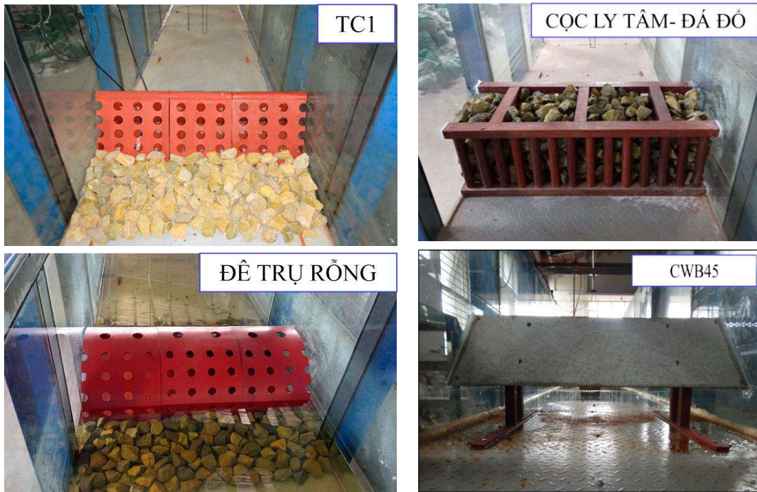
Hình 1: Các kết cấu thí nghiệm
