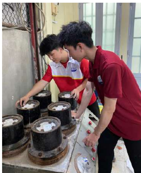
Hình 8: Thí nghiệm mác chống thấm của bê tông
