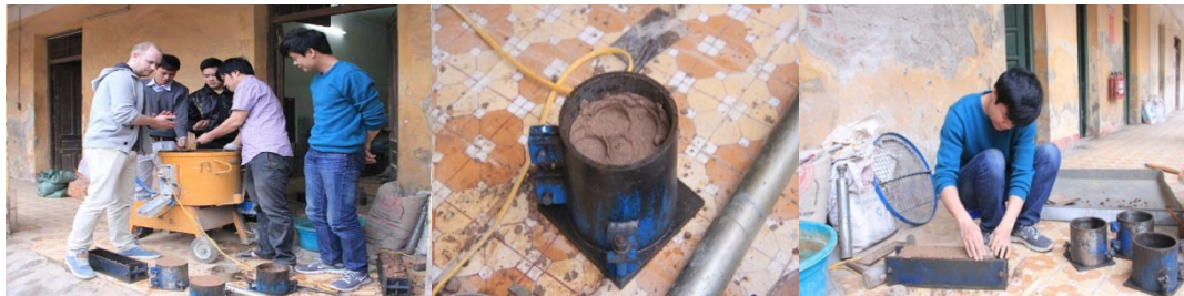
(a) Trộn đất và chất kết dính (b) Tạo mẫu nén (c) Tạo mẫu kéo uốn
