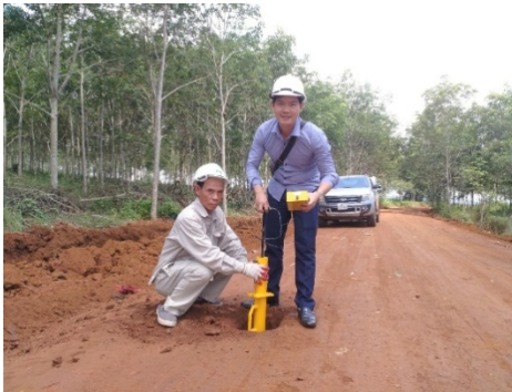
Hình 13. Thử nghiệm CBR nền đường và khảo sát nguồn tro xỉ nhà máy Nhôm Đắk Nông
