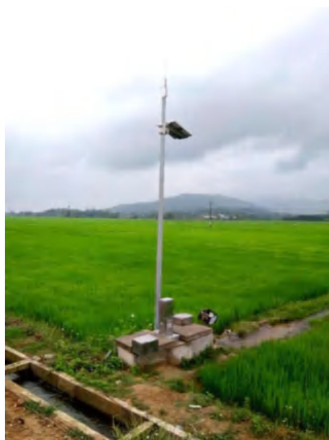
Hình 3: Trạm khí tượng và kiểm soát mực nước trên kênh tưới được lắp đặt tại kênh NVC2
