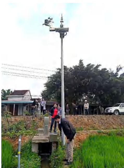
Hình 3: Trạm khí tượng và kiểm soát mực nước trên kênh tưới được lắp đặt tại kênh NVC2
