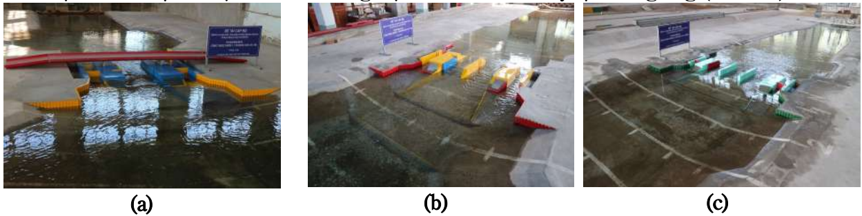
Hình 11. Nghiên cứu thí nghiệm mô hình thủy lực: (a) Cống 1 khoang cửa đại diện nhóm 1; (b) Cống 2 khoang cửa đại diện nhóm 2; (c) Cống 3 khoang cửa đại diện nhóm 3
