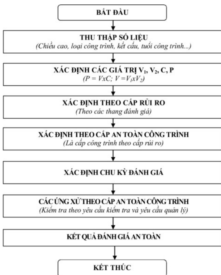
Hình 1: Sơ đồ quy trình đánh giá an toàn công trình đê điều
