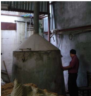
Hình 1: Lò đốt trấu kiểu giỏ lưới thép
