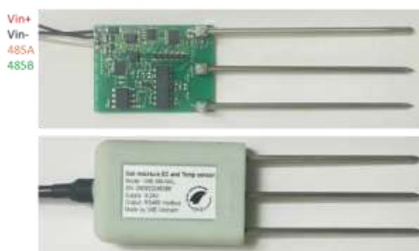
Hình 7: Mạch điện tử (trên) và sản phẩm cảm biến sau khi đóng vỏ đổ epoxy (dưới)
