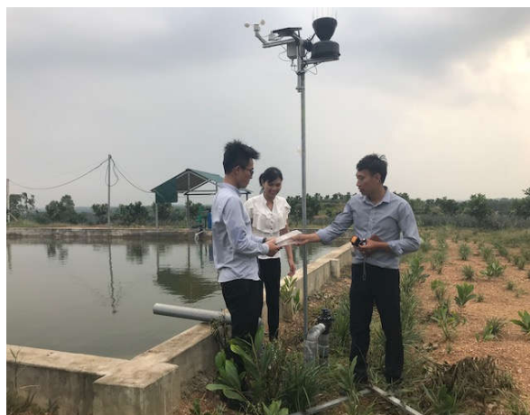
Hình 6. Hệ thống quan trắc các chỉ số khí hậu và thổ nhưỡng và hỗ trợ thực thi tưới và bón phân
