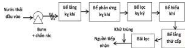
Hình 3: Sơ đồ công nghệ xử lý nước thải thôn Nam, xã Tân Tiến
