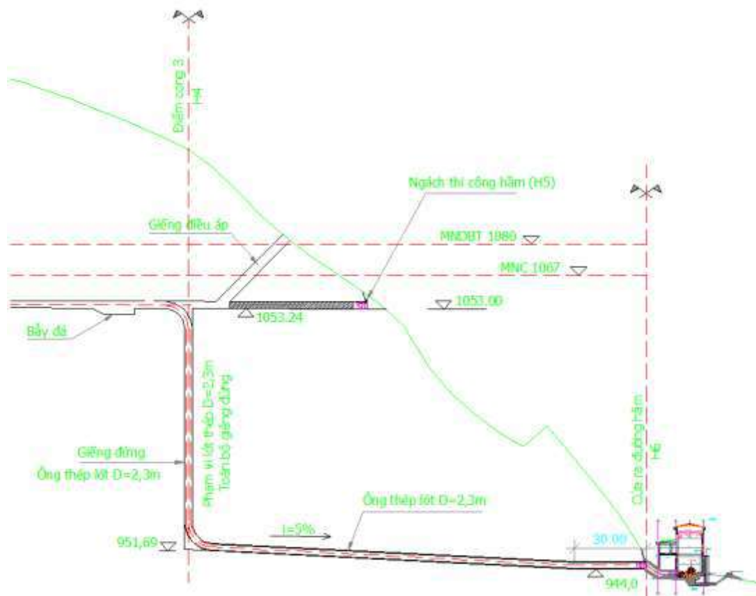
Hình 1: Sơ đồ minh họa hàm gom kết hợp tháp điều áp
