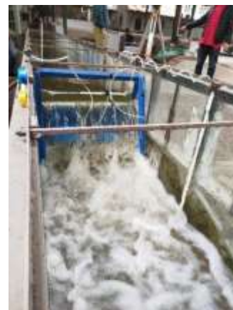
Hình 8: Dòng chảy trong máng nhìn từ thượng lưu, từ trên cao và từ hạ lưu
