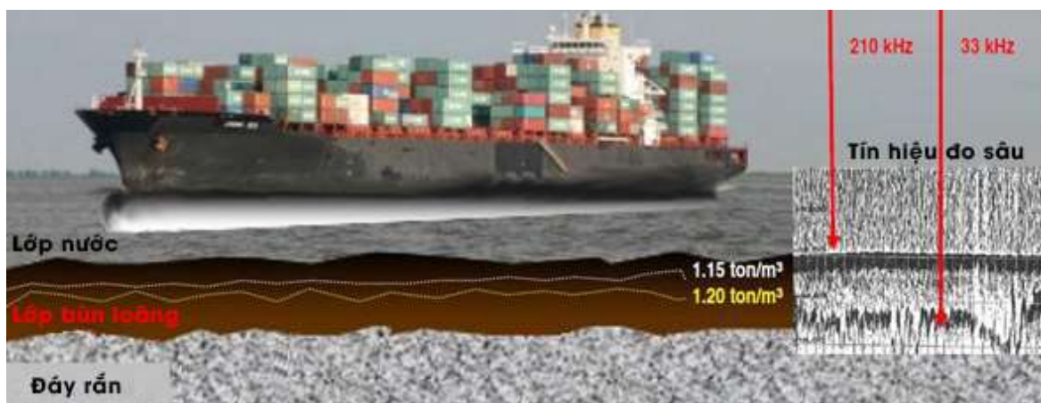
Hình 1: Độ sâu luồng được đo bằng thiết bị hồi âm đa tần (hình vẽ minh họa)
