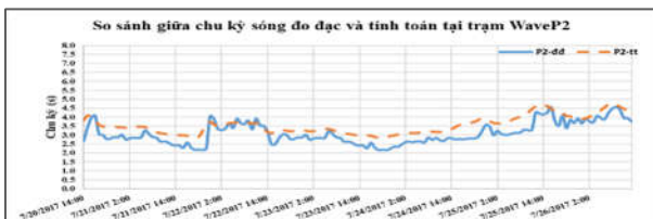
Hình 9: So sánh giữa chu kỳ sóng tính toán và đo đạc tại trạm WaveP2
