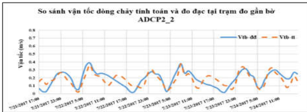
Hình 7: So sánh giữa vận tốc dòng tính toán và đo đạc tại WaveP2_2
